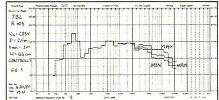
Distorsione per differenza di frequenze (3° ordine, Δf=40 Hz):
